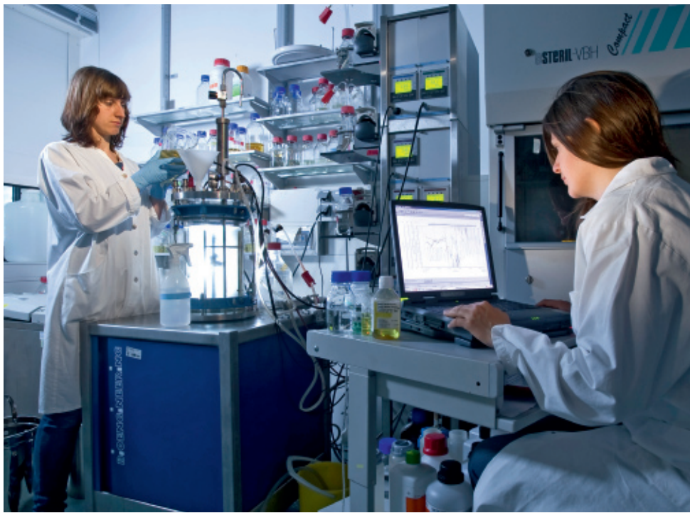
Janet Andert (links) füllt eine Kultur magnetotaktischer Bakterien in einen Fermenter (rechts in einer Detailaufnahme). Damit sich die Bakterien optimal vermehren, passt Antje Reinecke unterdessen die Bedingungen an.
