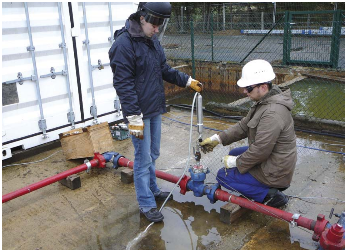
Abb. 20: Fluidprobenahme zur Bestimmung der Wasser- und Gaszusammensetzung an der Bohrung Horstberg
