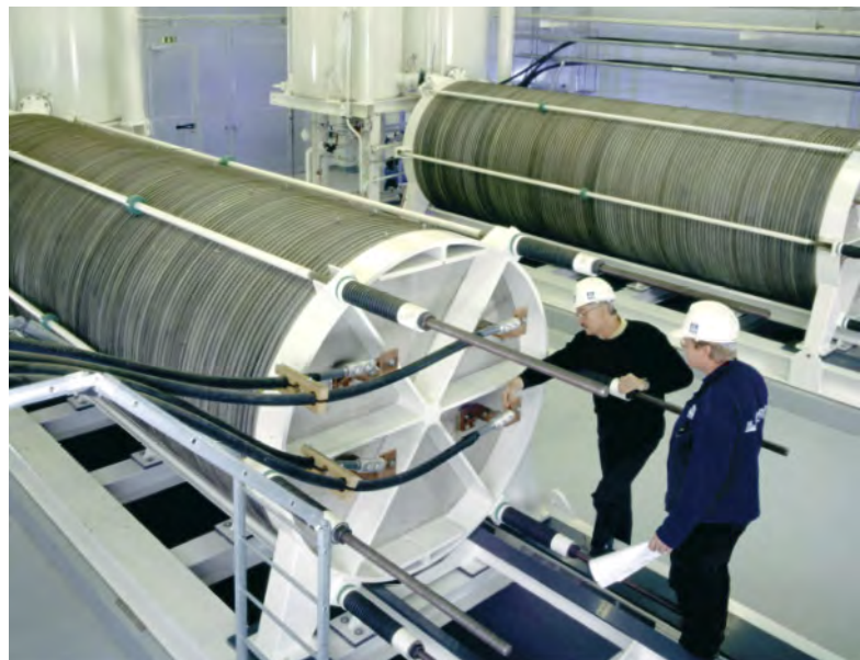
Mit diesem Elektrolyseur wird Wasser in seine Bestandteile Wasserstoff und Sauerstoff gespalten.
