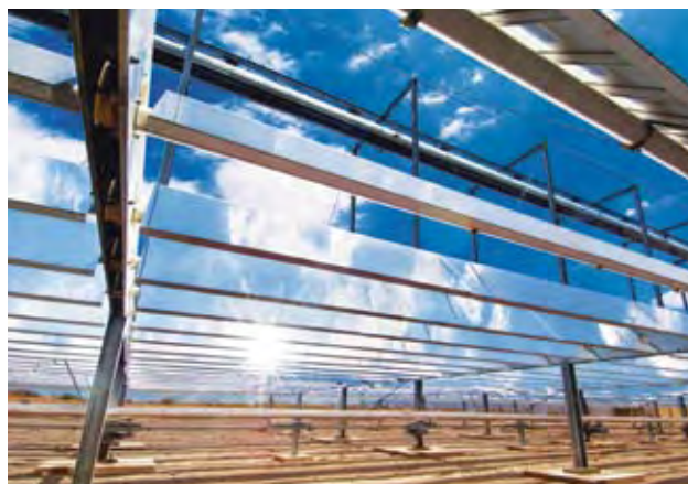
Fresnelkollektor auf der „Plataforma Solar de Almería“, Spanien
