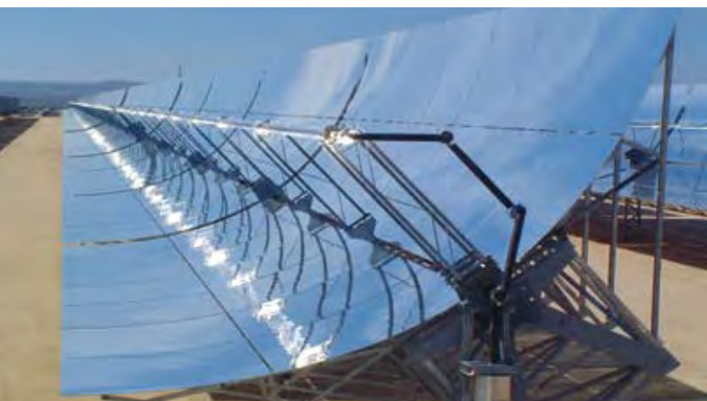
Europäischer Parabolrinnenkollektor SKALET im Testbetrieb
