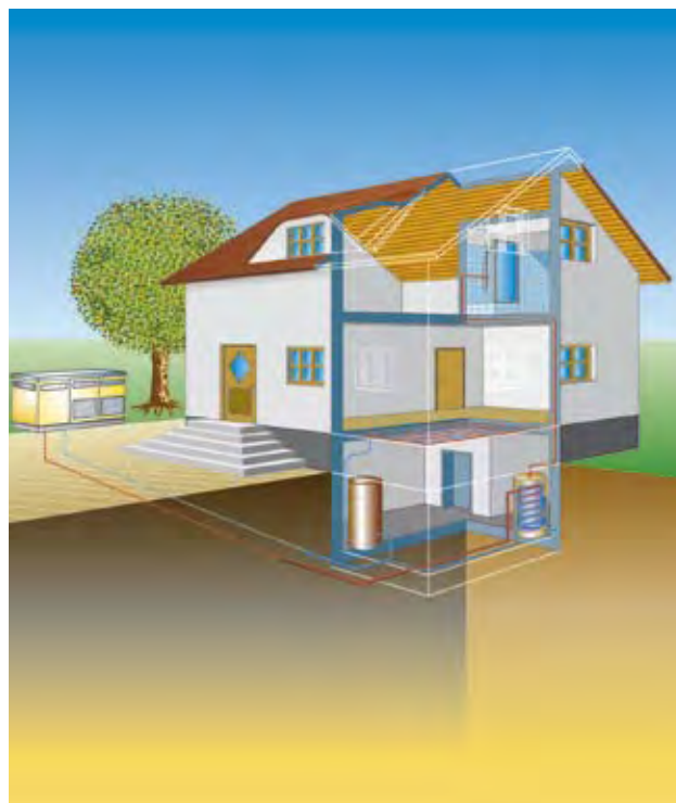
Luft als Wärmequelle für eine Wärmepumpe
