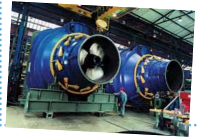
Turbine eines Wasserkraftwerks vor dem Einbau
