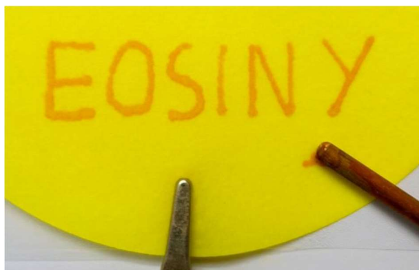
Abb.: Elektrochemisches Schreiben auf einem Filterpapier. Rechts ist die Kupferelektrode und in der unteren Mitte die Krokodilklemme zu sehen.
