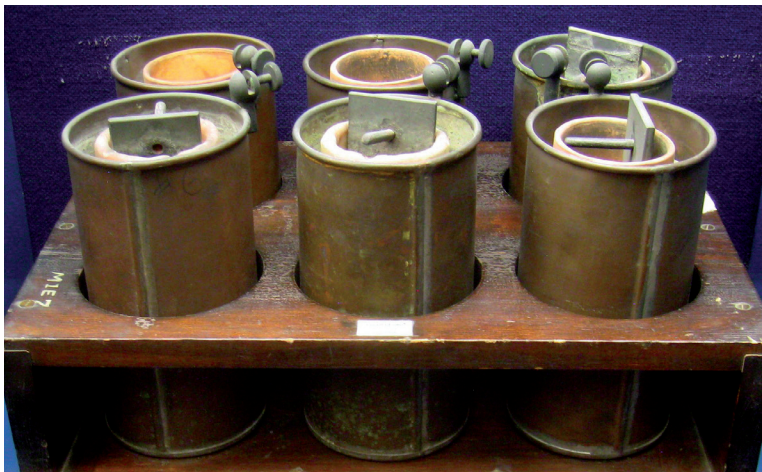
Abb. 17: Sechs Daniell-Elemente mit äußeren Kupfergefäßen ( https://commons.wikimedia.org/wiki/File:NMAH-Daniell_cell_batteries_1836.JPG ; Public domain)
