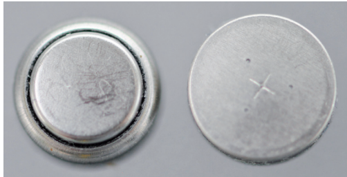
Abb. 10: Zink-Luft-Knopfzelle (Ober und Unterseite)
