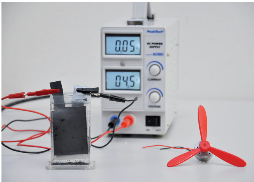
Abb. 24: Laden des Modell-Lithium-Ionen-Akkumulators
