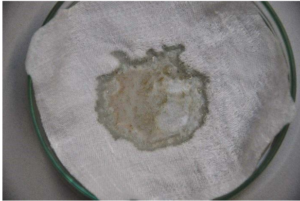
Abb.: konzentrierte Schwefelsäure auf weißem Baumwollstoff nach ca. 5 min
