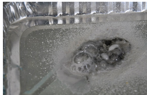
Abb.: Reaktion von Ätznatron mit Wasser auf Aluminium nach ca. 20 sec und 2 min
