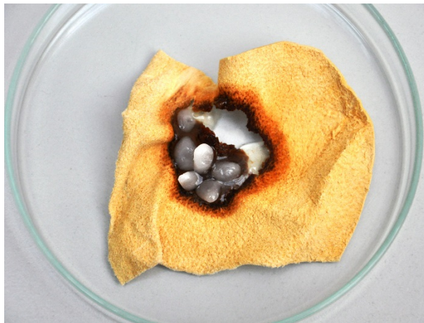
Abb.: Ätznatron auf feuchtem Fensterleder nach ca. 1 Stunde
