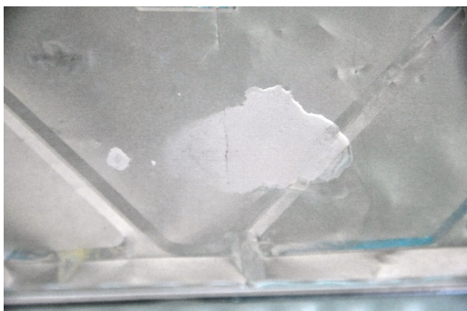
Abb.: Reaktion von Salzsäure (25%) auf Aluminium nach ca. 20 sec und 2 min
