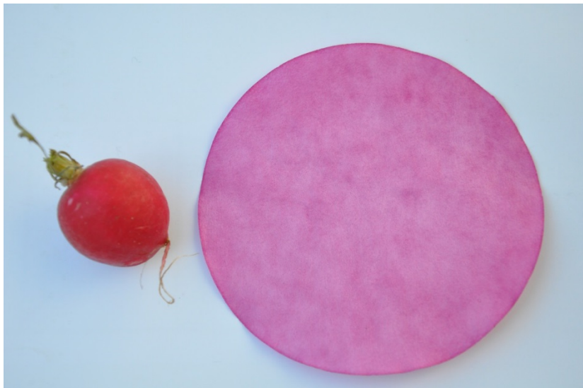
Abb.: Indikatorpapier aus mit Radieschenextrakt getränktem Filterpapier
