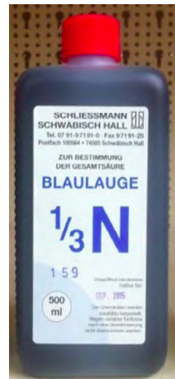
Abb. 27: Blaulauge zur Bestimmung des Säuregehalts in Wein
