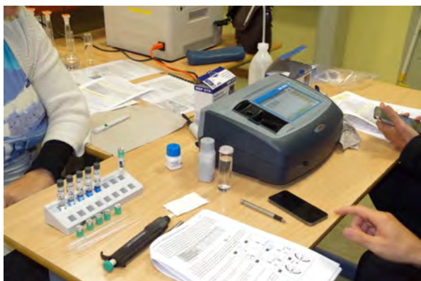
Abb. 16: Fotometrische Messung mit Extinktionsmessung bei einer Konzentrationsreihe und Eichgerade mit Excel erstellt
