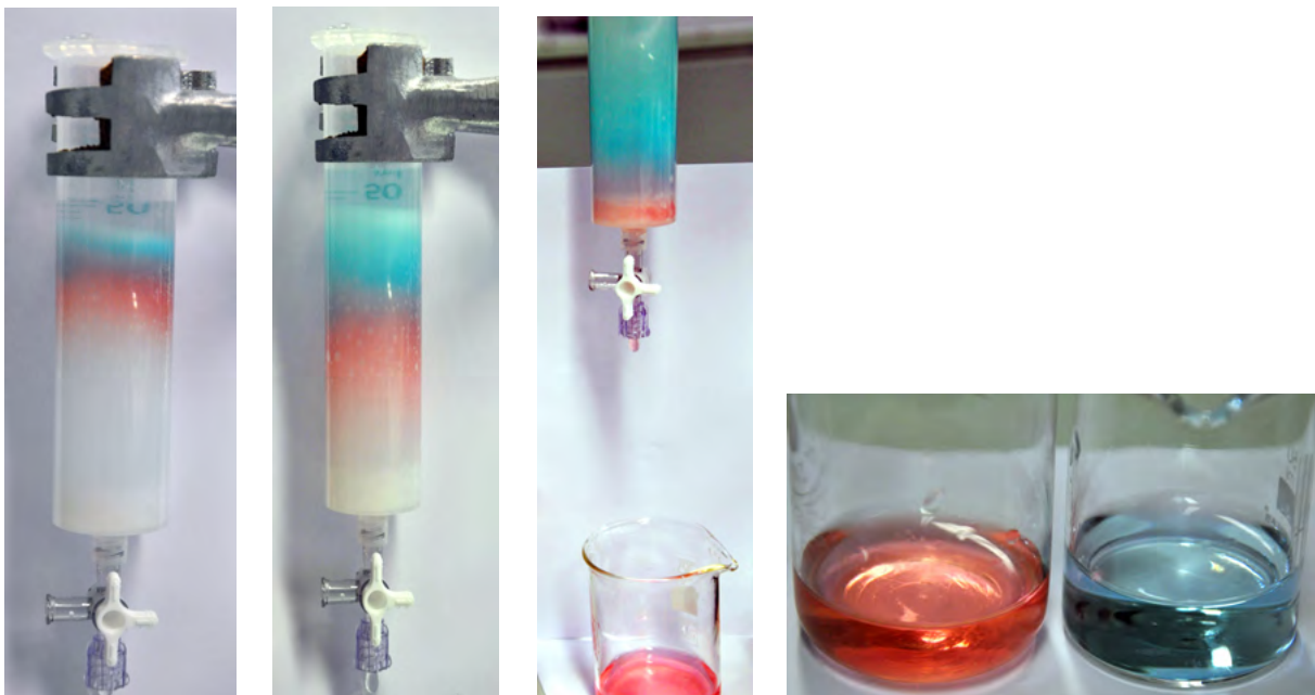
Abb. 21: Untersuchung (Trennung) eines Farbstoffgemischs eines Limonadenpulvers (Kool Aid), Laufmittel Wasser
