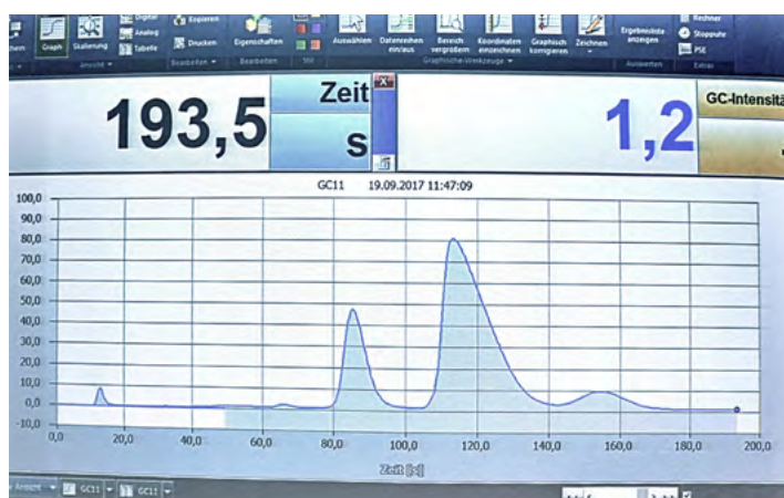
Abb. 22: Untersuchung von Feuerzeuggas mit AKGC15K und Software
