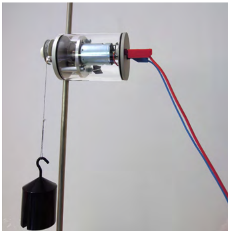
Abb. 21: Modellaufzug mit Masse und Elektromotor
