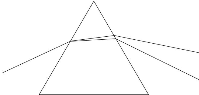
Beim Übergang von einem **optisch dichteren** (z. B. Glas) in einen **optisch dünneren** Stoff (z. B. Kunststoff) wird das Licht ab einem bestimmten Einfallswinkel *vollständig an der Grenzfläche reflektiert*. Diese Erscheinung heißt **Totalreflexion**. Der Einfallswinkel, bei dem der Brechungswinkel gerade  $90^\circ$  ist, heißt **Grenzwinkel** der Totalreflexion und wird mit  $\alpha_G$  bezeichnet.
