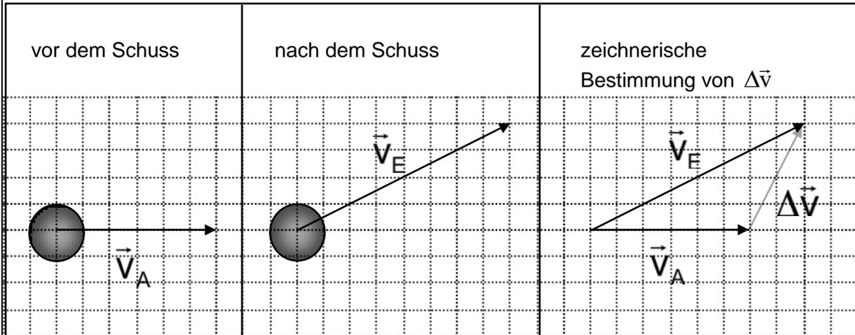
In den folgenden Bildern ist in drei Situationen der heranrollende Ball unmittelbar vor dem Schuss mit seiner Anfangsgeschwindigkeit vorgegeben. Zeichne einen Pfeil für die Endgeschwindigkeit, so dass der Ball in Richtung Tor rollt. Ermittle dann die Zusatzgeschwindigkeit, die der Ball durch den Schuss des Spielers erhalten muss.
